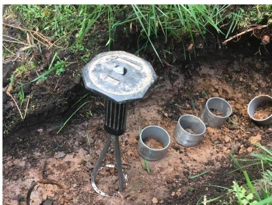
**Abbildung 12: Gewinnung von 100 cm<sup>3</sup> fassenden Bodenproben mittels Stechzylindern bei Versuchen im Solling, Niedersachsen.**
