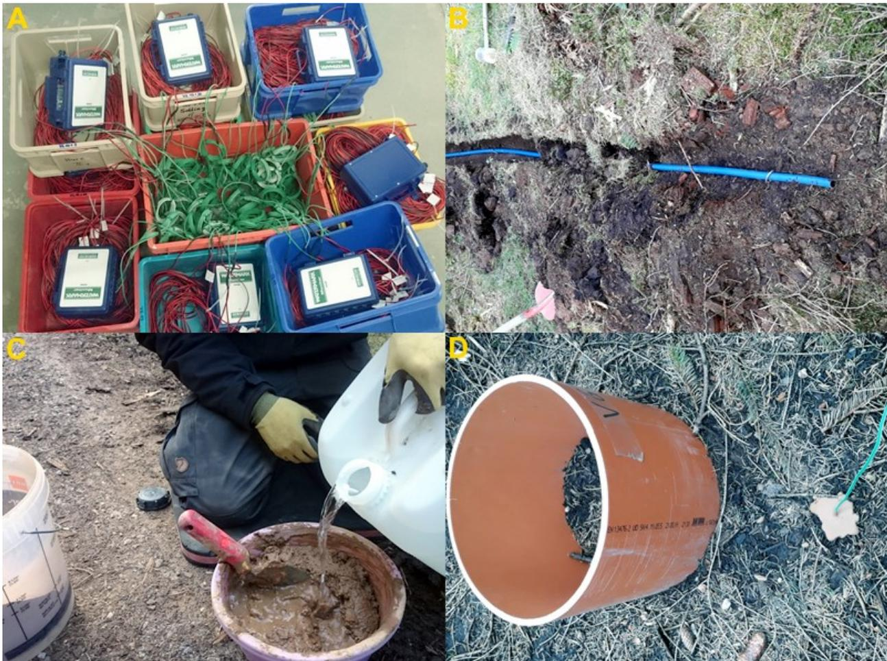
**Abbildung 23: Datenlogger und Sensoren (A), Leerrohr als Überführungshilfe für Sensorkabel (B), Zubereitung von Lössschlämpe (C) und ein neben einer Respirationshaube eingebauter Sensor (D) (Fotos: © Siebrecht, U., Sparrer, J.).**
