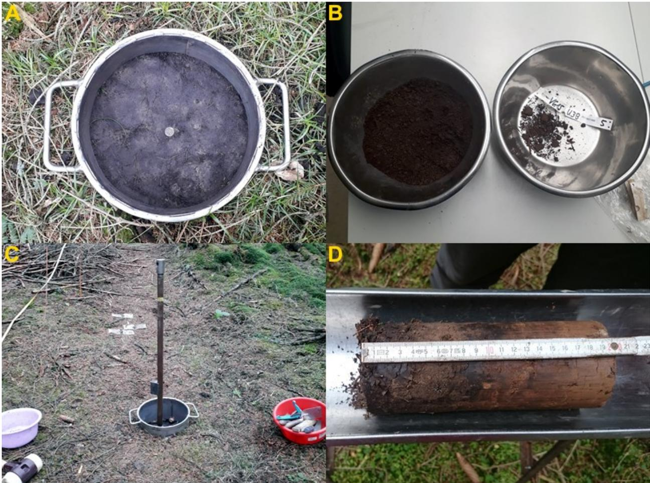
**Abbildung 40: Beprobung der Humusauflage (A), Vorbereitung von Bodenproben (B), Beprobung des Mineralbodens mit einem Wurzelbohrer (C) und Separation entnommener Bodenkerne in Tiefenstufen (D) (Fotos: © Siebrecht, U., Sparrer, J.).**
