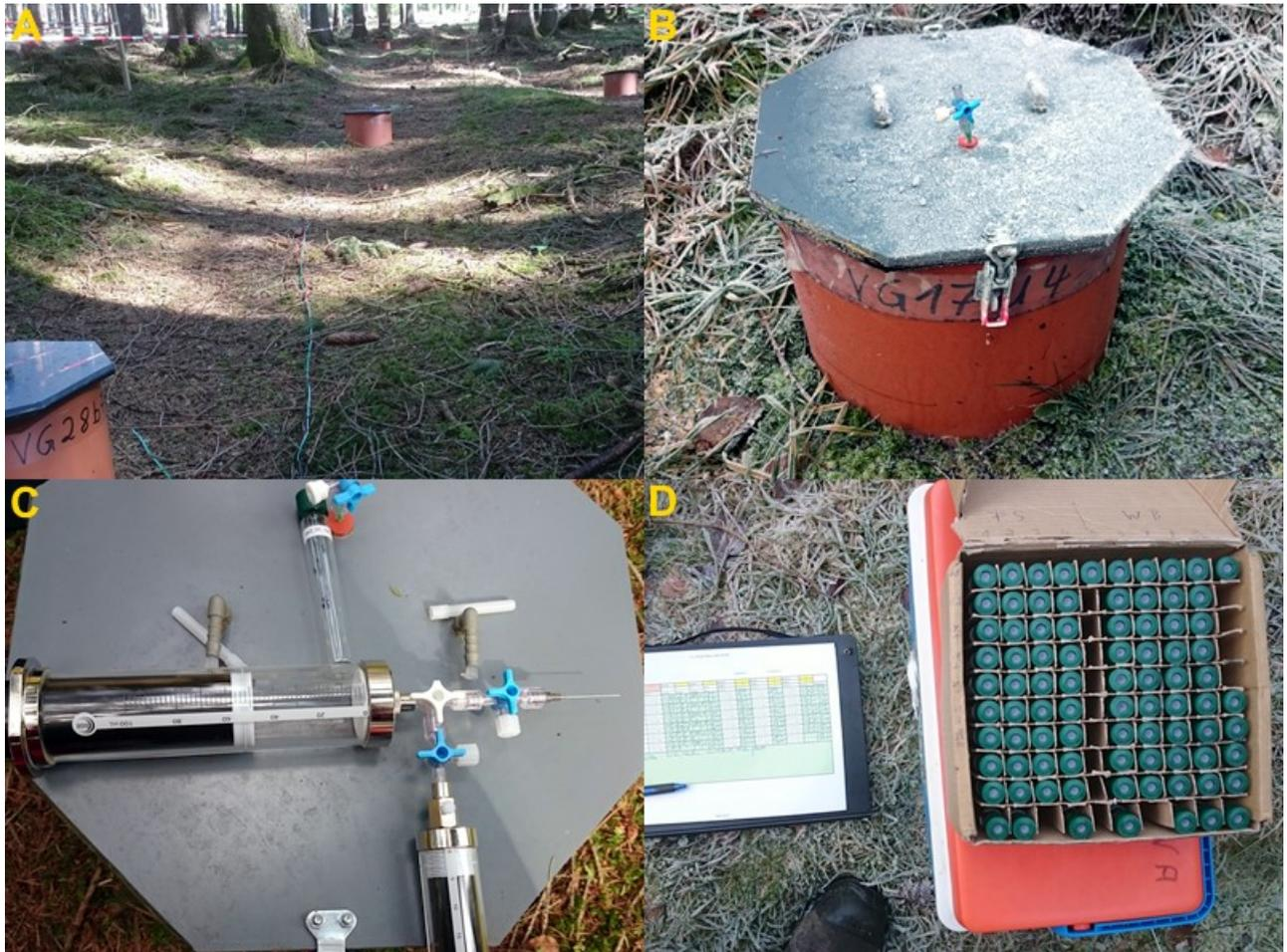
**Abbildung 32:** Auf der Versuchsfläche aufgestellte und verschlossene Respirationshauben (A+B), Methode der Überführung einer Gasprobe in eine Sammelspritze (C) sowie zur Befüllung vorbereitete Exetainer während einer Beprobung *in situ* (D) (Fotos: © Siebrecht, U.).
