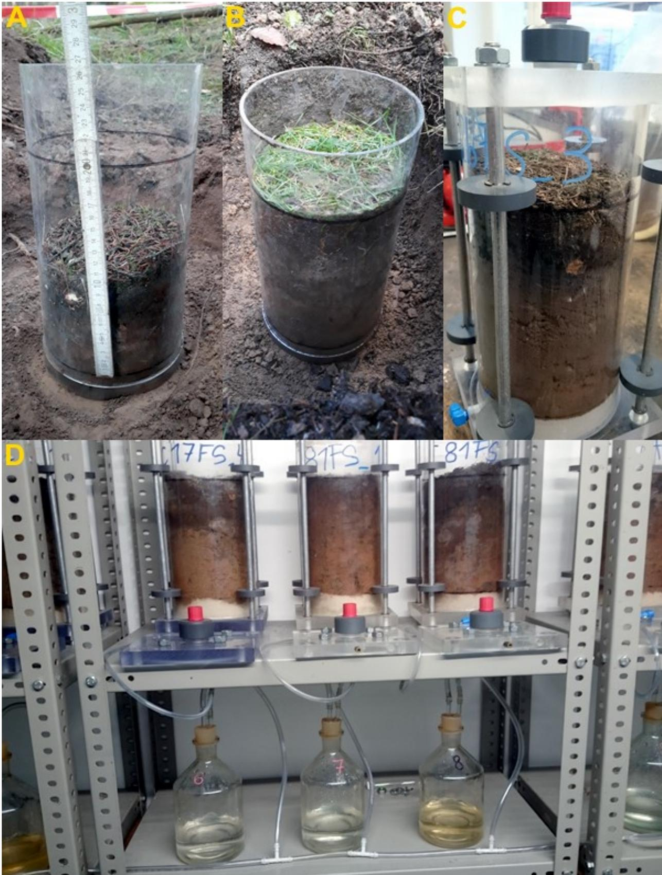
Abbildung 63: Gewinnung ungestörter Bodensäulen (A+B), Vorbereitung und Installation einer Säule in der Haltevorrichtung (C) und Aufbau des Messsystems in Kühlkammer (D) (Fotos: © Siebrecht, U., Sparrer, J.).
