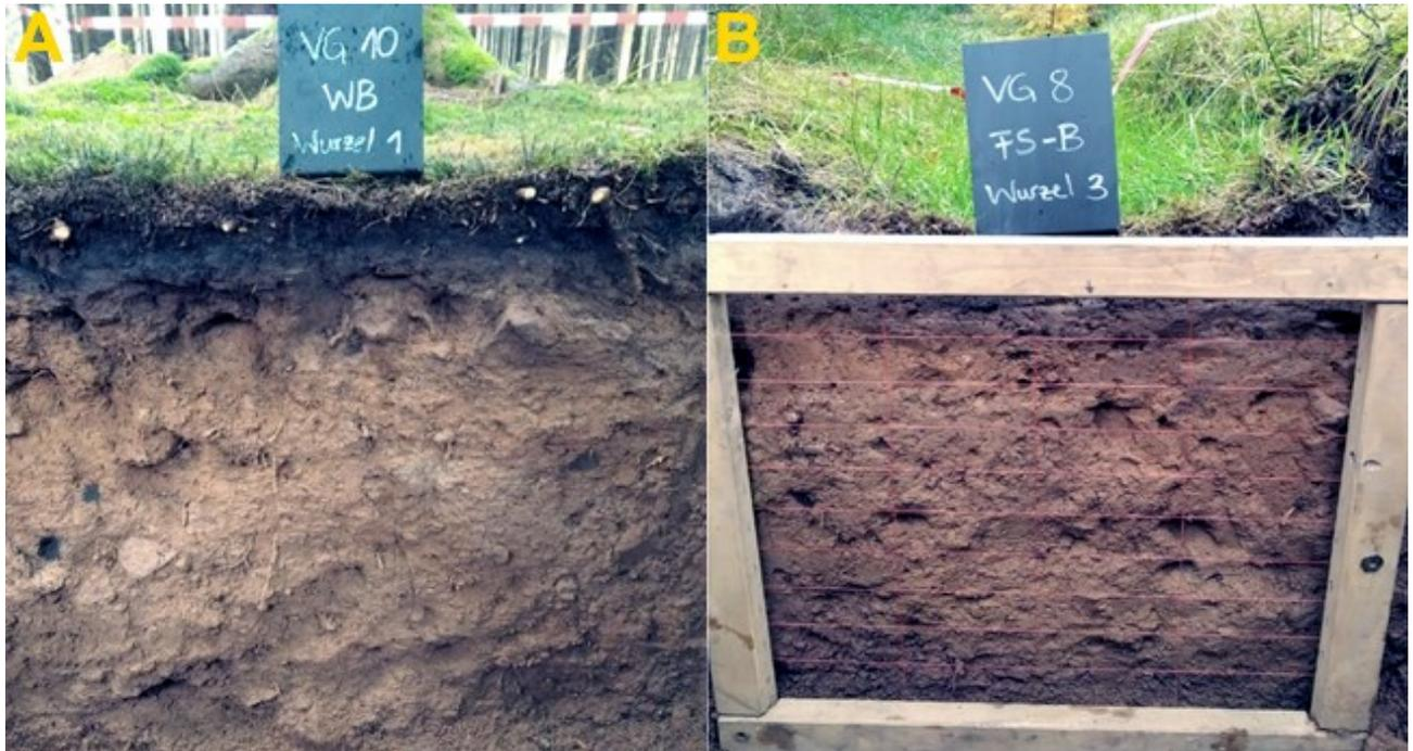
Abbildung 67: Profilwand einer unbefahrenen Referenzparzelle (A) und einer Fahrspur mit befestigtem Zählrahmen (B) (Fotos: © Valenzik, K.).
