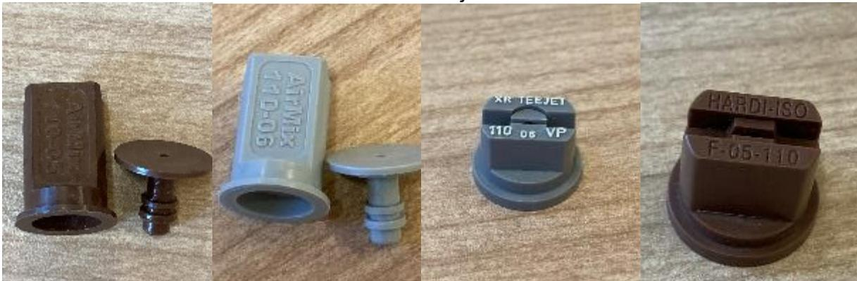
Abbildung 18: Vier für Prüfungen vorausgewählte Flachstrahldüsen.
