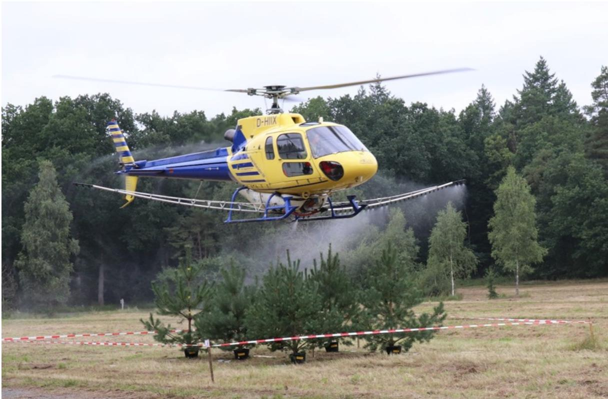
Abbildung 20: Helikopterapplikation über der Behandlungsfläche. Erkennbar ist der Ausfall von Düsen.
