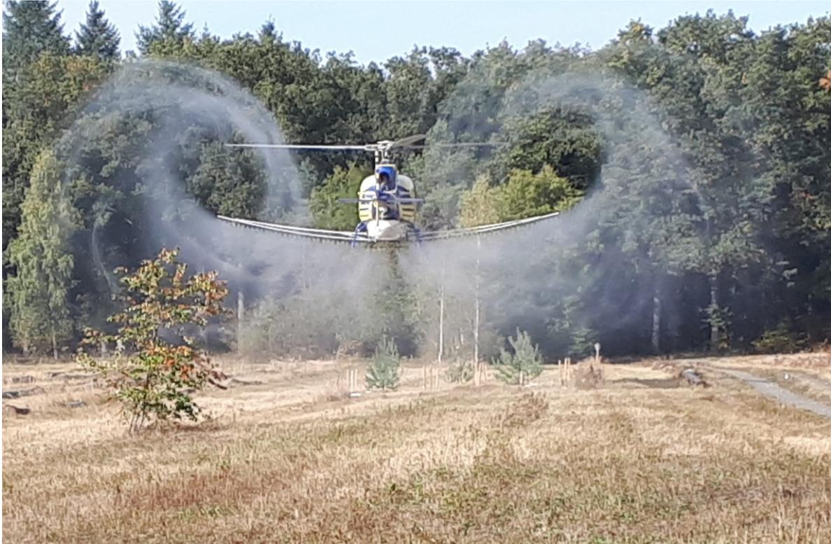
Abbildung 17: Beispielhafter Schleppwirbel. Foto: M. Habermann.
