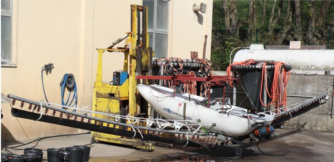
Abbildung 26: Auf einem Gabelstapler aufgespanntes Helikopterspritzgestänge mit Spritztank. Unter die 33 auf jeder Gestängeseite angebrachten Flachstrahldüsen wurden Rinnen zum Auffangen der Spritzflüssigkeit befestigt.
