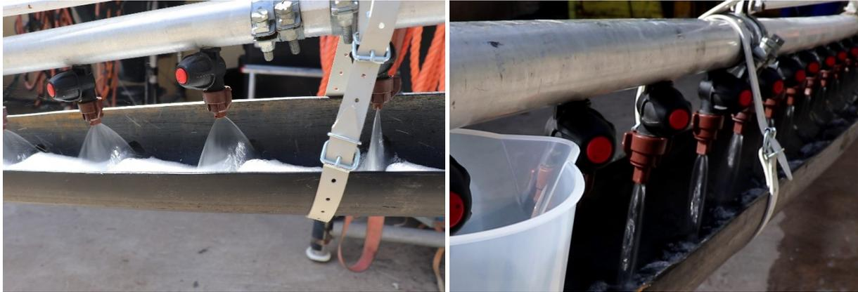
Abbildung 27: Sprühvorgang der Formulierung durch Spritzgestänge und Düsen während des Optimierungsversuchs. Links im Bild: Formulierung durch Hardi-Düse ISO-F 110-05; rechts im Bild: Formulierung durch Standarddüse AirMix 110-05.
