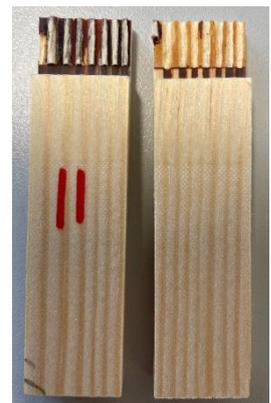
Abbildung 15. Längszugscherfestigkeit und Holzversagen verklebter unbehandelter und modifizierter Kiefer.
