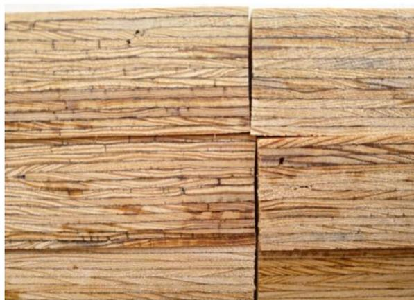
Abbildung 12: Plattenquerschnitte von bei 90 °C vorbehandelten Schälstämmen (oben links und links Mitte) und bei 70 °C vorbehandelten Furnieren (Rest).
