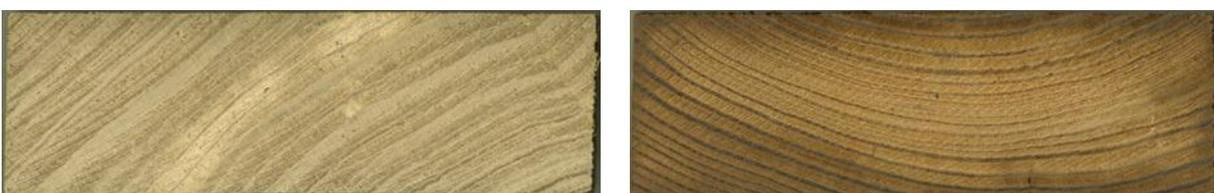
Abbildung 13. Brettquerschnitte mit teilweise unvollständiger Modifizierung (helle Bereiche).
