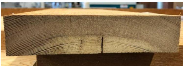
Abbildung 4. Unvollständig modifiziertes Brett mit Hirnriss.
