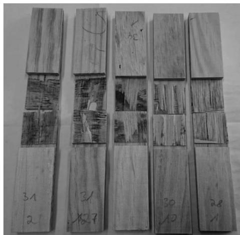
Abbildung 7: Bestimmung des Holzbruchanteils (von links nach rechts)
