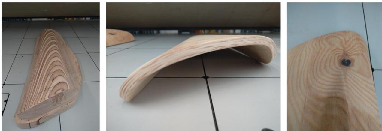
Abbildung 7: Formwerkzeug und Vakuumpresse mit umgeformter Kieferfurnierplatte mit gesperrten Lagen und rissfreier Oberfläche trotz Totast im Formwinkel.
