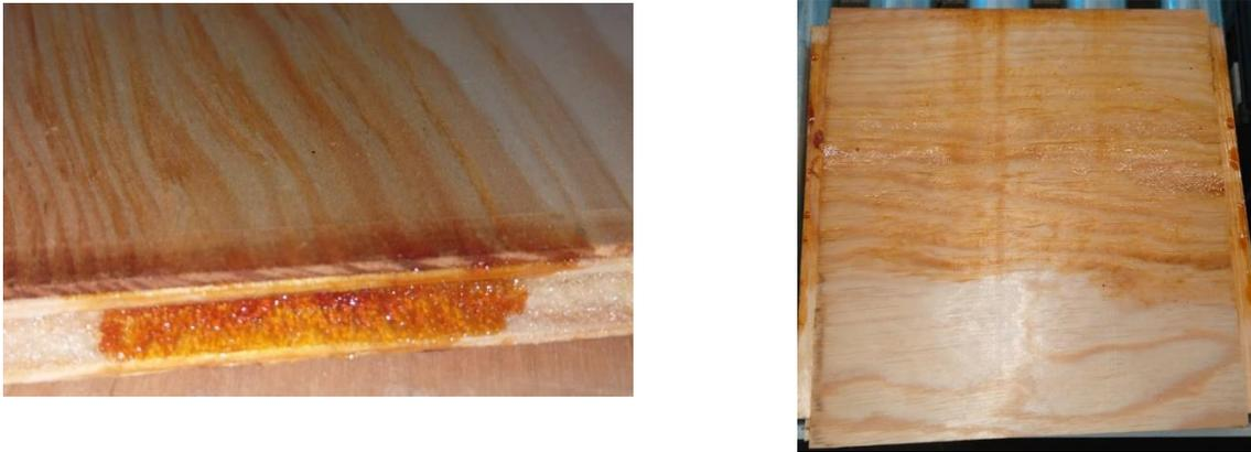
Abbildung 10: links: seitlich austretendes Harz; rechts: Sperrholzoberfläche bei Heißverpressung harzreicher Furniere
