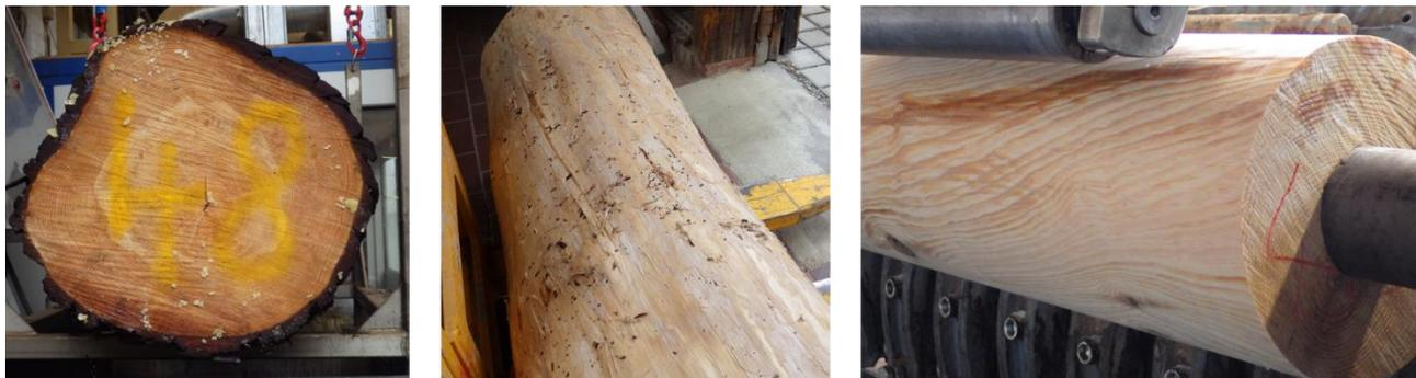
Abbildung 1: Prozess der Schälurnierherstellung mit Kiefernstamm bei 70 °C plastifiziert mit Harzausblühungen, ein Kiefernabschnitt im entrindeten Zustand und abschließend während dem Schälprozess von Spindeln geführt.
