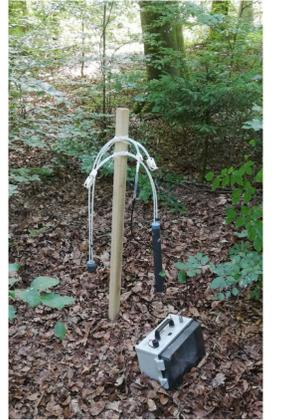
Abb. 3: Eine von 48 Lysimeterstationen für das monatliche Sampling von Bodenwasser in der Buchenfläche Bachs.
