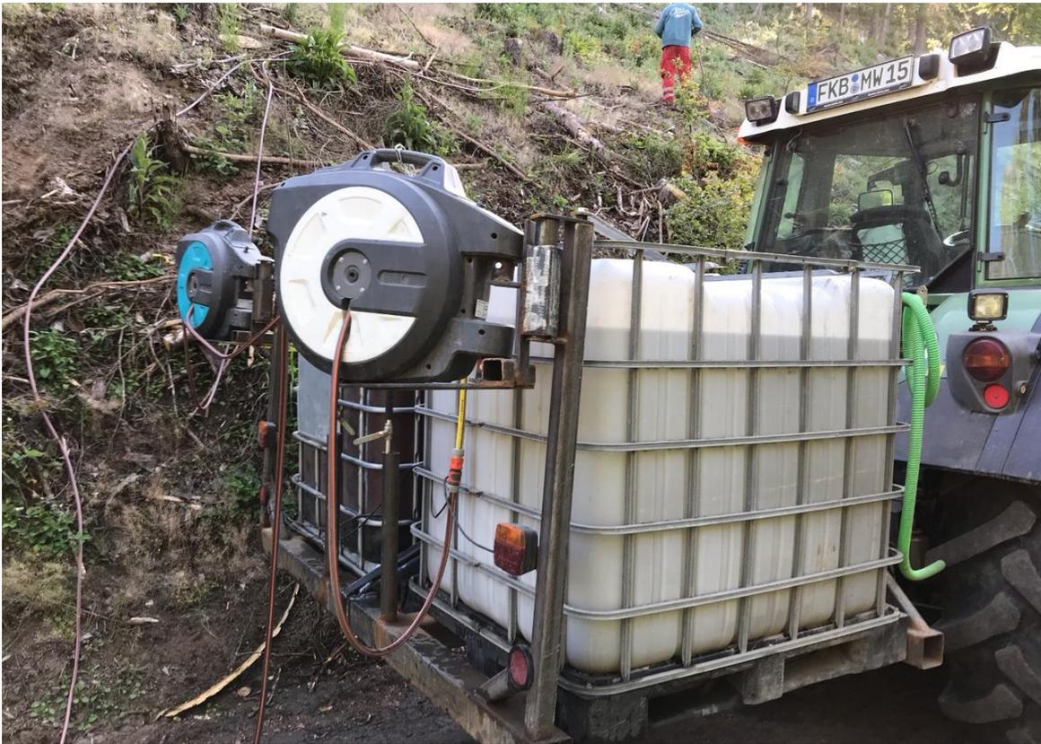
Abbildung 11: Foto "Frankenberger-Bewässerungsverfahren", Heckbehälter mit Schlauchhaspeln, (Biederbick, 2020)
