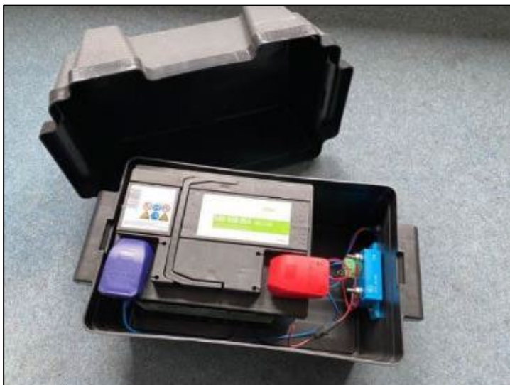
Abbildung 46: Batteriekasten mit KFZ-Akkumulator und Spannungswächter
