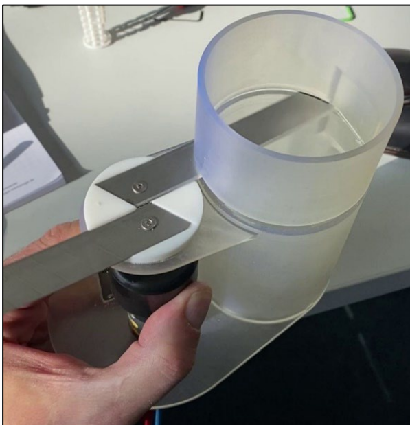
Abbildung 56: Versuchsaufbau Abtöten der Zielorganismen mittels rotierender Klinge
