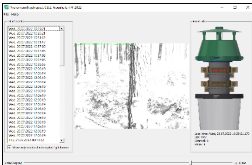
Abbildung 50: Software-Tool zur Analyse des Anflugverhaltens und zur Auswertung von Zählereignissen
