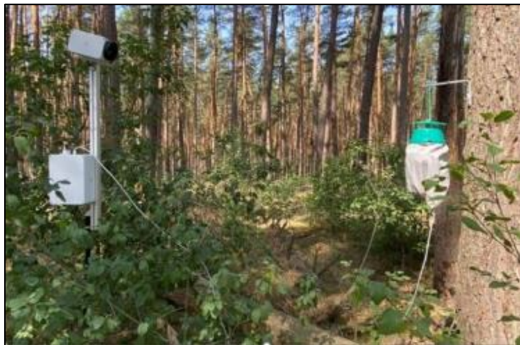
Abbildung 48: Fallensystem mit Zählmechanismus und Kameraüberwachung in Kiefernbestand
