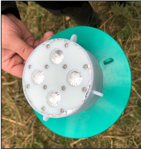
Abbildung 35: Blisterreservoir mit vier Ködern
