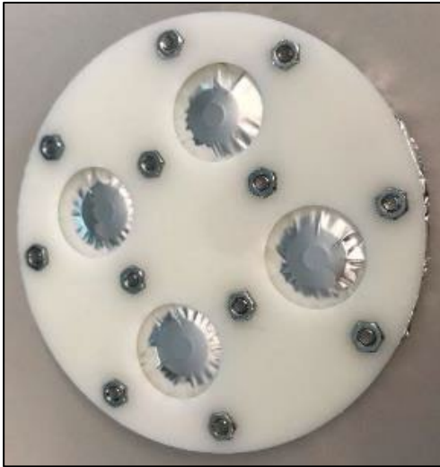
Abbildung 11: Entwurf einer Versuchsanordnung zur Pheromonabgabe mittels Blistersystem (beispielhafte Darstellung)
