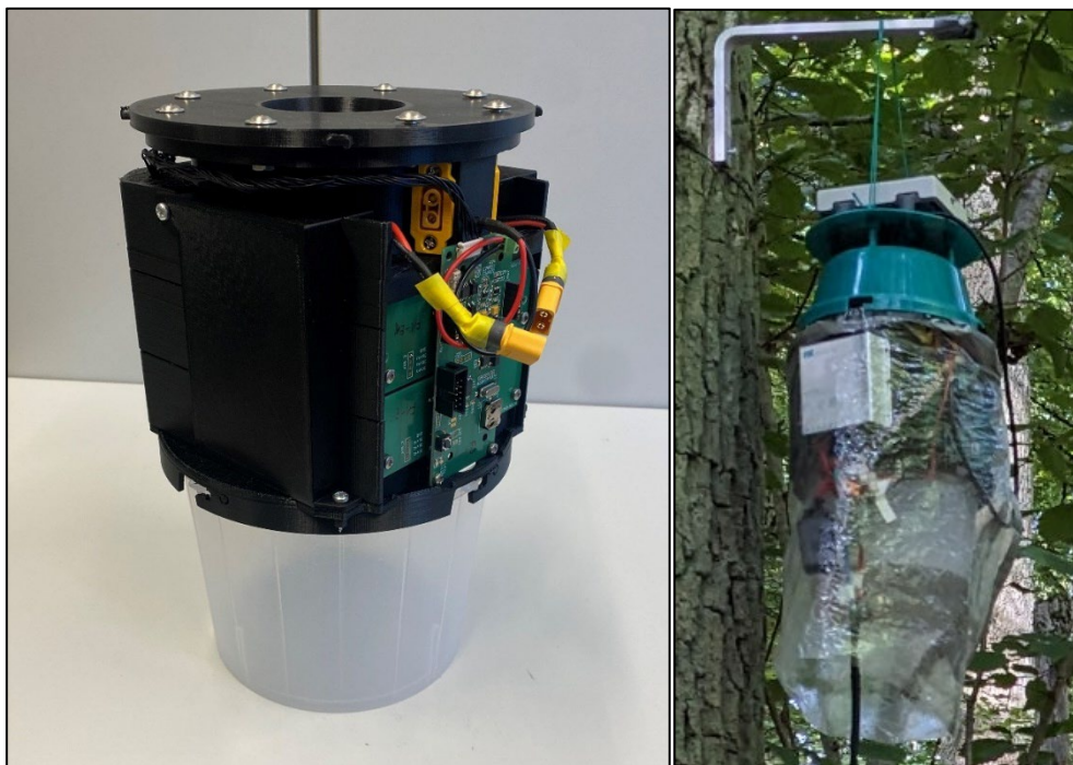
Abbildung 79: rechts: Zählfalle der 3. Generation (ohne Wetterchutz und oberem Einfülltrichter), links: Vollfunktionsfähige Zählfalle der 3. Generation mit Wetterchutz und allen Modulen.
