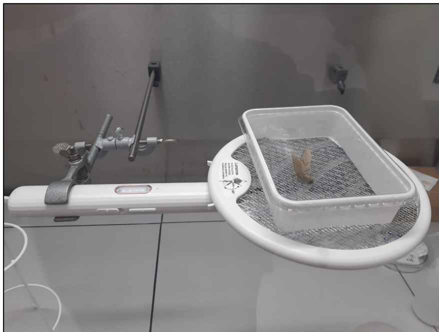
Abbildung 54: Laborversuch Abtötung: Elektrische Abtötung ohne Sicherheitsgitter
