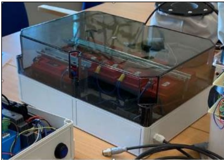
Abbildung 45: Großes Multi-Akku-Pack für kamerabasierte Zählfälle
