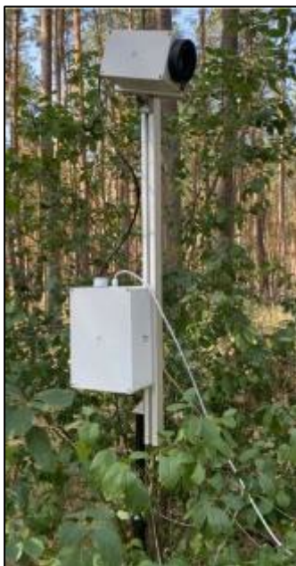
Abbildung 43: Kamera in IP65-Gehäuse auf Stativ (oben)
