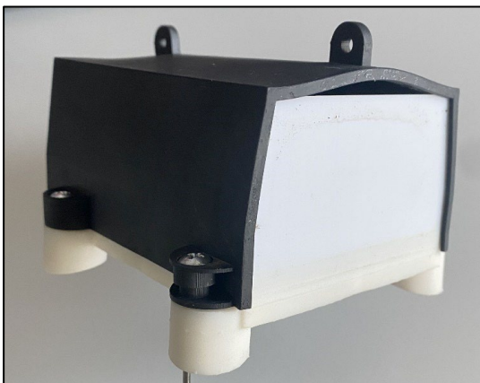
Abbildung 38: Verformter Deckel des automatischen Festködermoduls der ersten Generation
