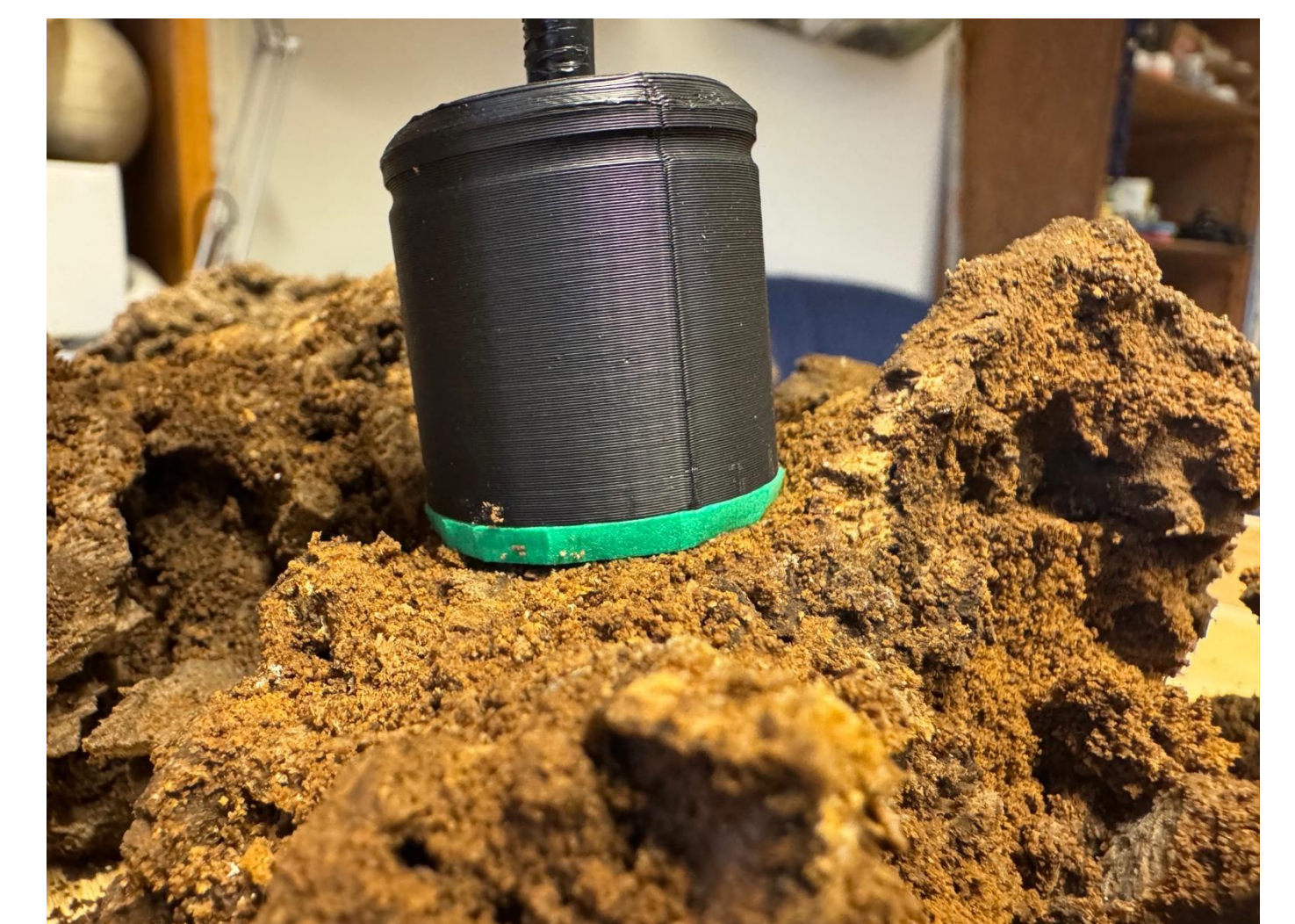
Abb.6: Endgültiger Prototyp der Feuchtemesssonde in Totholz
