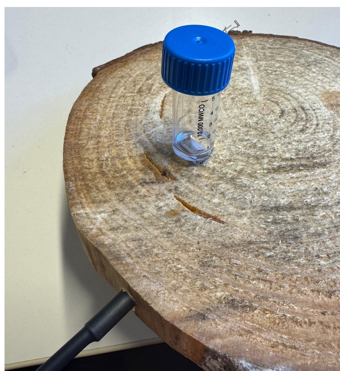
Abb.4: Saugkerze und Temperatursensor in Picea abies Scheibe
