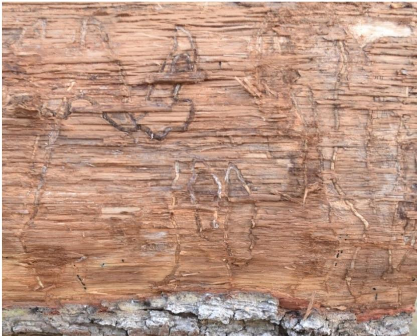
Abb. 18: Wirr (überwiegend jedoch quer zur Holzfaser) verlaufende, zum Ende hin breiter werdende Fraßgänge mit auch nach dem Abheben der Borke fest gepresstem feinem Bohrmehl verstopft. Das Splintholz wird dabei nur flach gefurcht. Hier am liegenden Stamm fotografiert.
