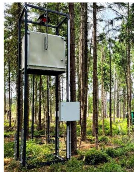
**Abb. 3:** Versuchsanlage zur Messung von Treibhausgasflüssen im Großen Eisenstraßenmoor im Erzgebirge
