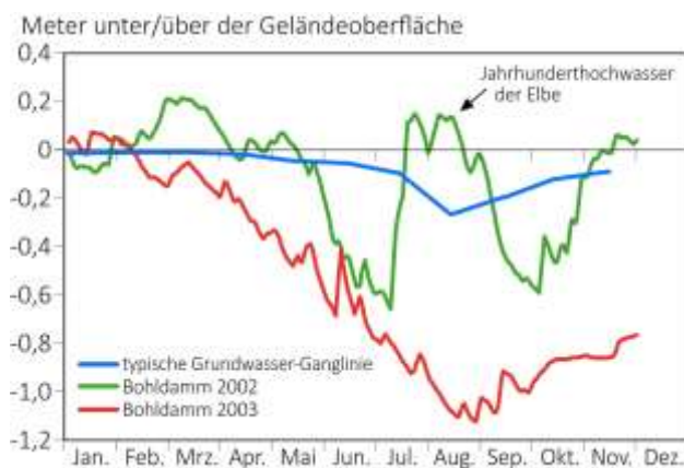
Abb. 3: Grundwasserstände zweier Jahre im Vergleich zu der typischen Grundwasser-Ganglinie eines intakten Erlenbruchs
