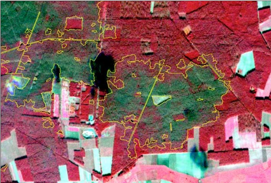
**Abb. 3: Automatisierte Erfassung von Nadelfraßschäden durch Kiefern großschädlinge aus RapidEye-Satellitendaten**
