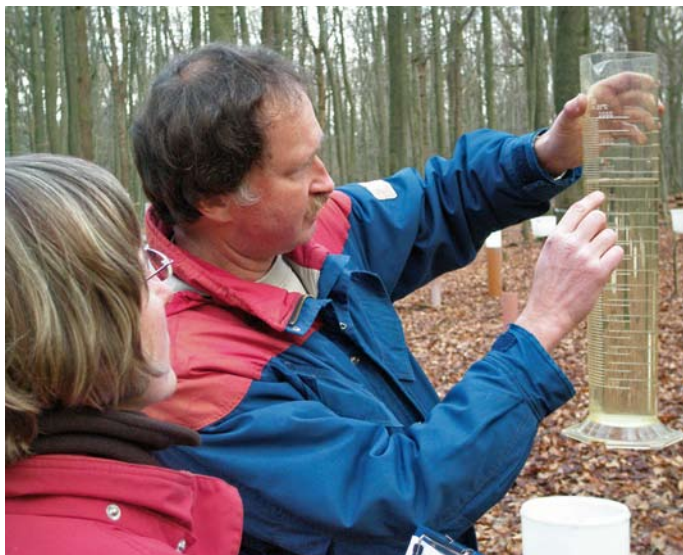
Erfassung der Niederschlagsmenge
