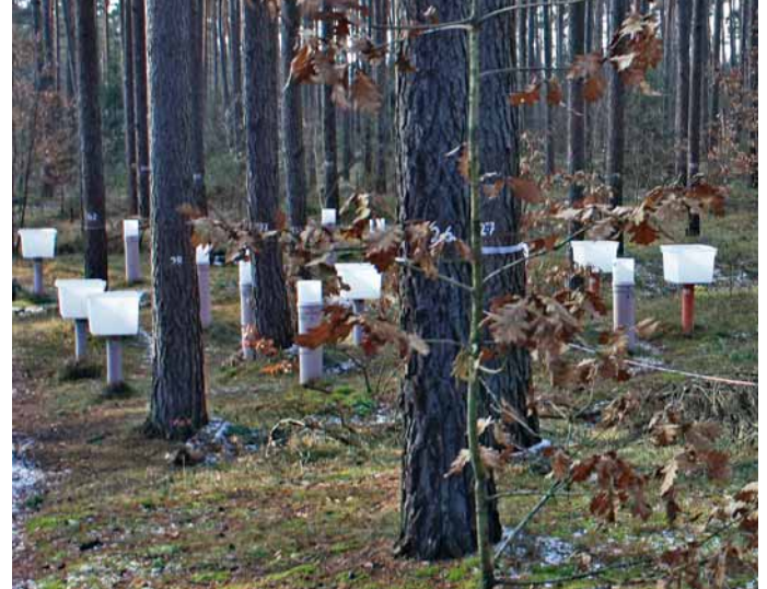
Level II-Fläche Klötze mit Depositions- und Streusammlern
