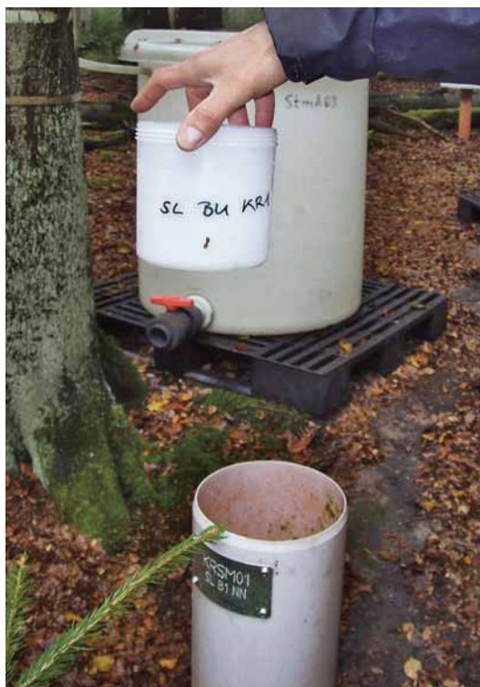
Entnahme eines Schwermetall-Sammelgefäßes Foto: NW-FVA
