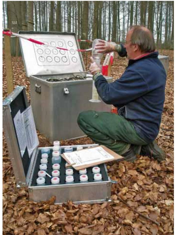
Probenahme von Bodensickerwasser
