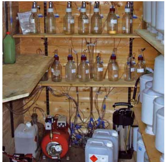
Mit Unterdruck wird Bodenlösung aus verschiedenen Bodentiefen gewonnen
