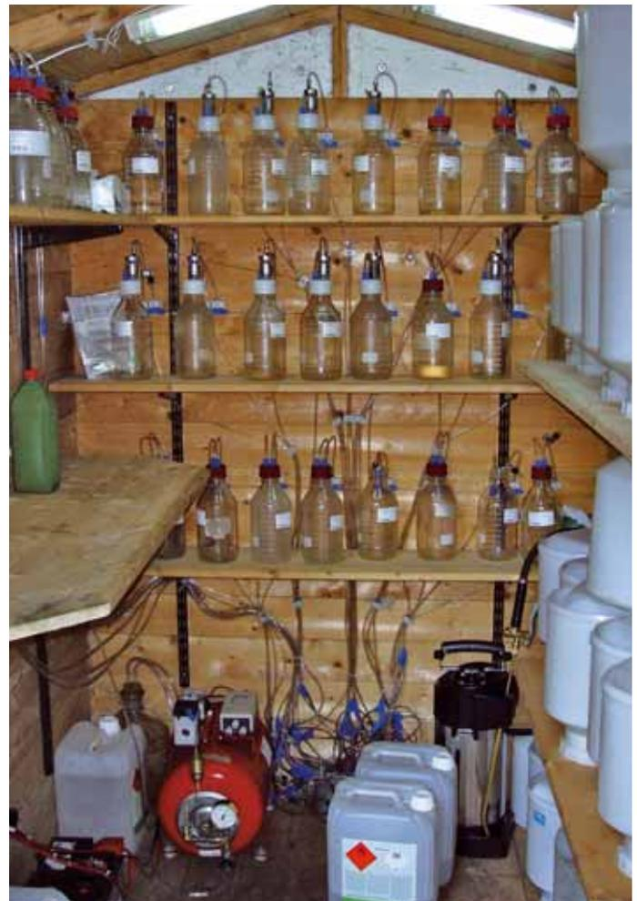
Mit Unterdruck wird Bodenlösung aus verschiedenen Bodentiefen gewonnen
