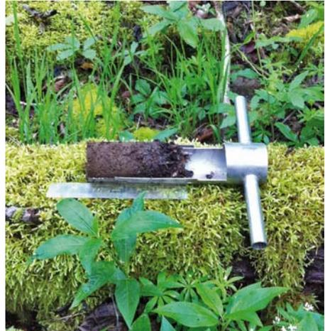
Aufgeklapptes Stechrohr (Durchmesser 5 cm) zur Entnahme von Bodenproben für die Kleinringelwürmerfassung
