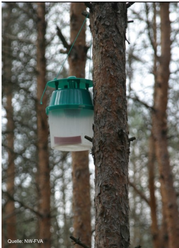
Abb. 1: aufgehängte Pheromonfalle Variotrap in einem Kiefernbestand
